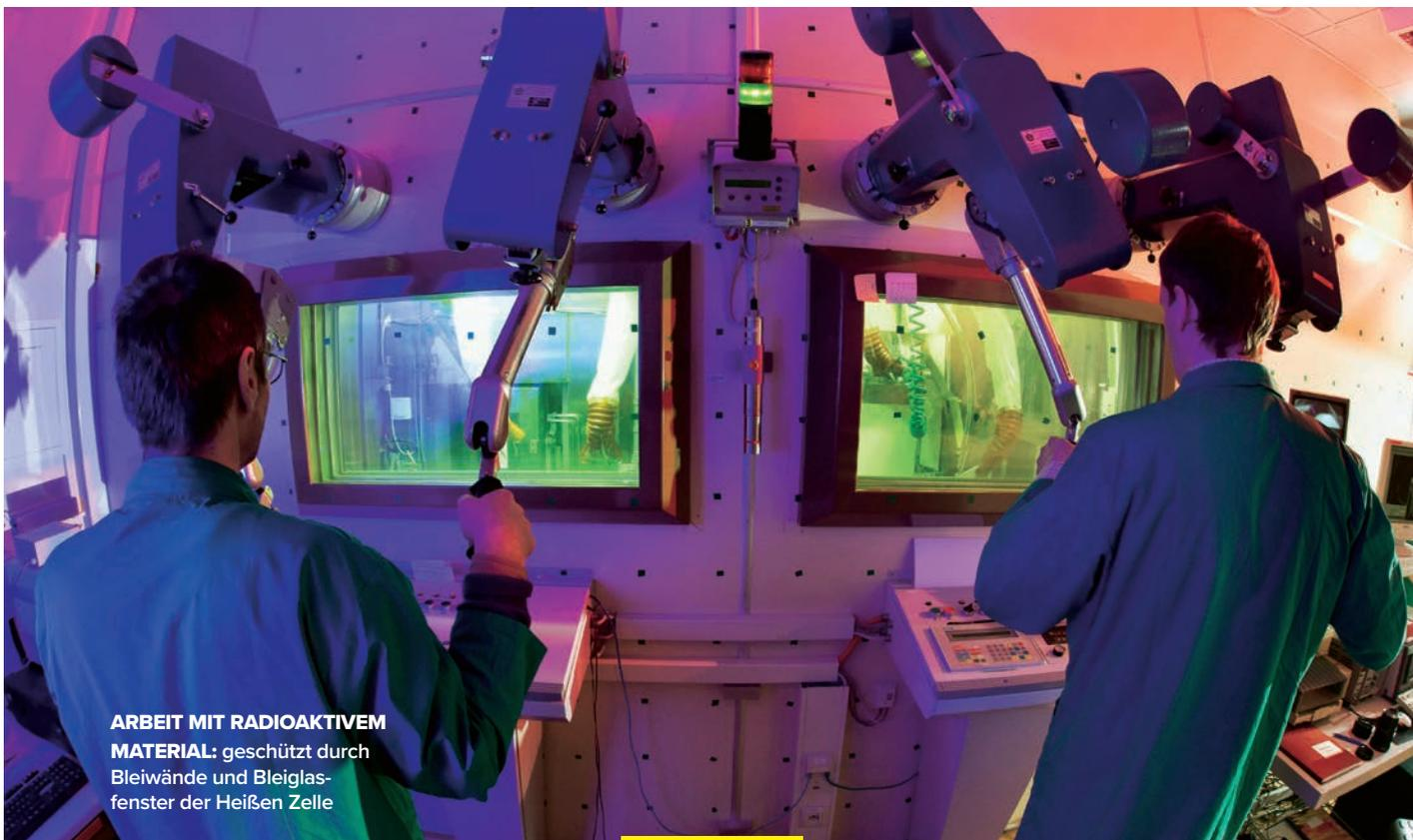
**ARBEIT MIT RADIOAKTIVEM MATERIAL:** geschützt durch Bleiwände und Bleiglasfenster der Heißen Zelle
